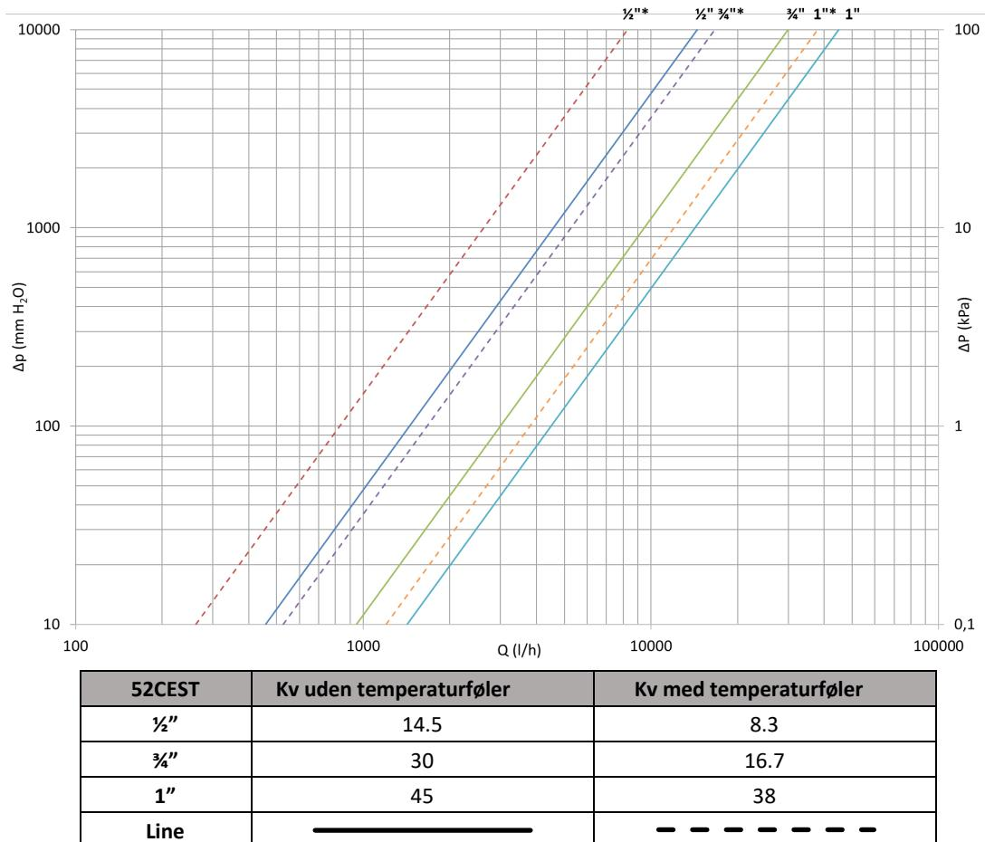
**!** Kv værdierne med temperaturføler er opnået ved at bruge en passende temperaturføler, som overholder beskrivelsen under afsnittet "Temperaturføler".
