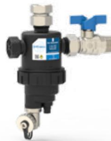
Magnetisk snavssamler til lodret montering med 3/4" mufte tilslutning og 3/4" nippel kugleventil
