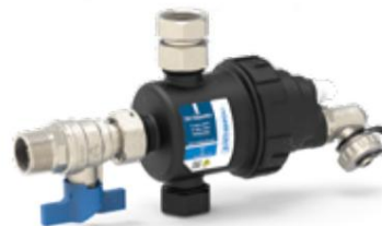
Magnetisk snavssamler til vandret installation med 3/4" mufte tilslutning og 3/4" nippel kugleventil
